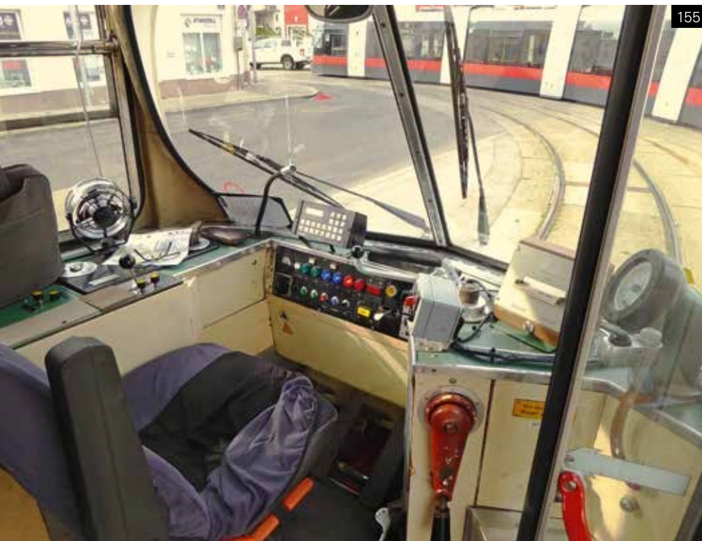
Abb. 155 (2016): E 1 4744 (*1971) Fahrerplatz Links im Fensterbrett der Fahrschalter (Fahren/Bremsen, Schienenbremse) und davor Fahrrichtungsschalter, über dem Armaturenbrett das Kästchen des Bordinformati- onsystems (auch Liniencodierung), rechts davon Sander- (oben) und Schienenbrems-Betätigung (darunter), über der Handbremskurbel die Aussenspiegelsteuerung. Neben dem Tacho (ganz rechts) das Kästchen für die Liniencodierung mit Kassette (ausser Betrieb). Am Boden drei Pedale (z.T. verdeckt), von links: Ablendschalter Scheinwerfer, Signalglocke, Feststellbremse. Die Schienenbremse kann über den Fahrschalter und das rechte Pedal ausgelöst werden.
