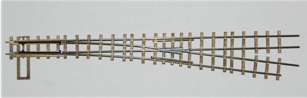
Im Vergleich zu den üblichen Weichen der üblichen Modellbauindustrie ist diese maßstäbliche Modellweiche natürlich länger und erheblich schlanker. Damit werden Schmalspurmodule oder Dioramen unvergleichlich elegant. Der Bausatz (rechts/links) wird nach dem Prinzip des *railboys*® Gleises montiert. Weichenzungen, Herzstück und Lenker bestehen aus Neusilberguss. Die Bauanleitung samt 1:1 Geometrieplan ist beige packt.
