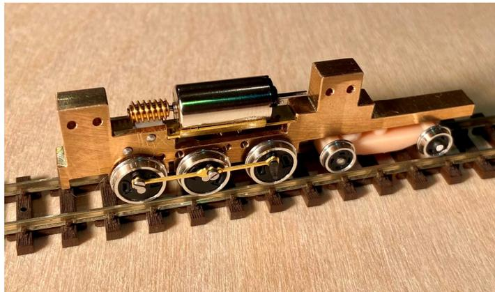
Fahrwerk mit gefrästen Messingrahmen und Glockenankermotor
