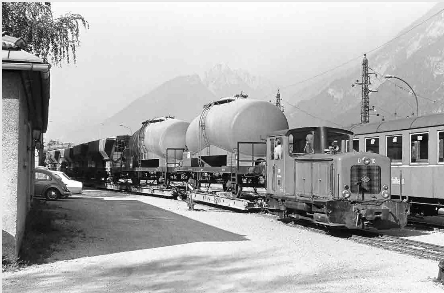
Am 7. September 1971 verschiebt die Maschine D 10 in Jenbach einen Güterzug. Zu dieser Zeit war es alltäglich, dass Normalspurwaggons aufgeschemelt transportiert wurden. Foto: Alfred Luft
