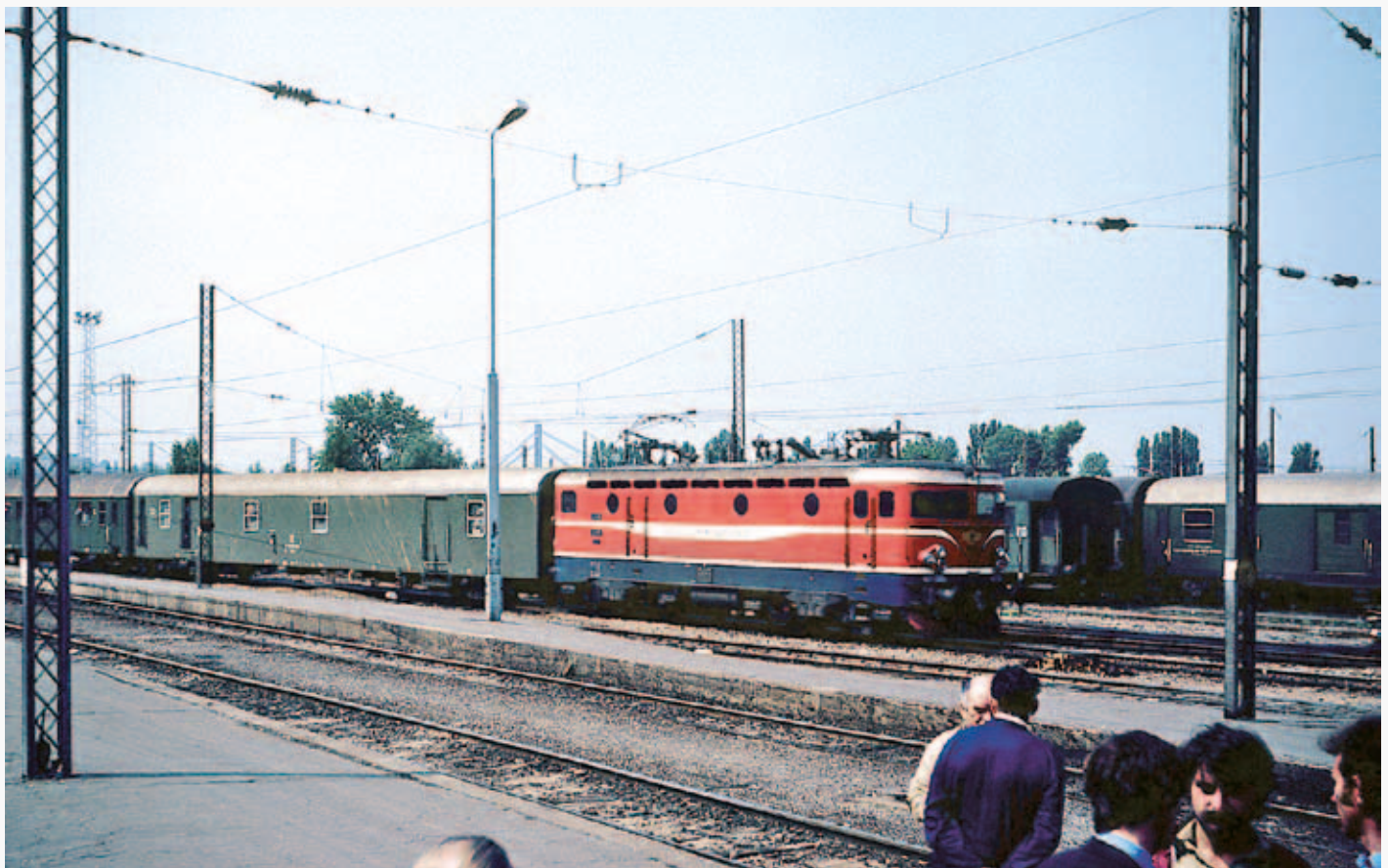
Mit einem Personenzug fährt die 1972 gebaute Elektrolokomotive JŽ 441-066 (25 kV 50 Hz) in Beograd (Belgrad) am 14. Mai 1982 ab. Am ersten Blick erkennt man eine leichte Verwandtschaft mit der Reihe 1043 in Österreich.
