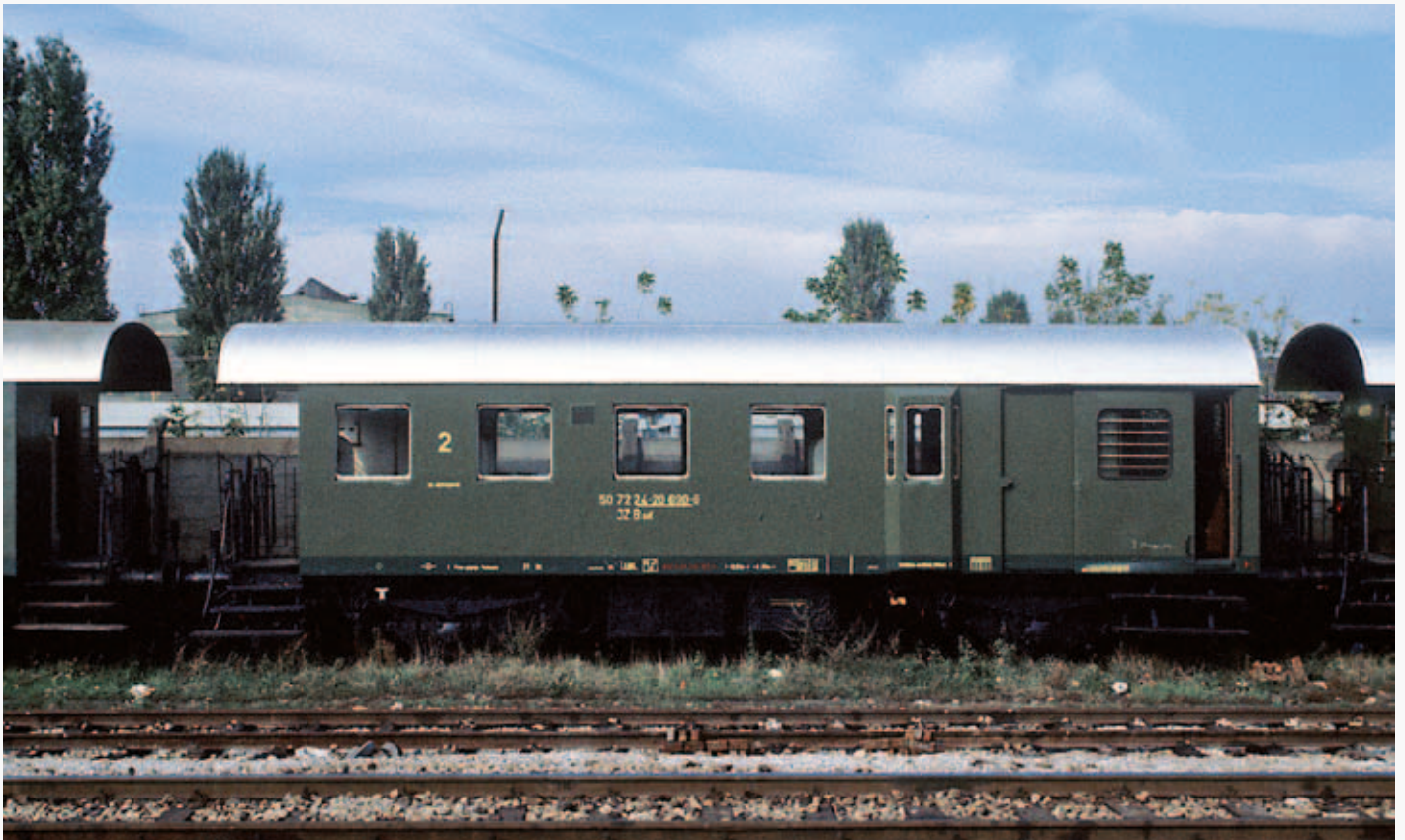
Im Bild der JŽ Baat 50 72 24-20 690-8, ex ÖBB BDi, in Niš am 14. Oktober 1984. Hier handelt es sich um einen Personenwagen mit Gepäckabteil und einer Aussichtskanzel für den Schaffner/Zugbegleiter. Mit Hilfe dieser Kanzel konnte sich der Schaffner einen Überblick über den ganzen Zug verschaffen.
