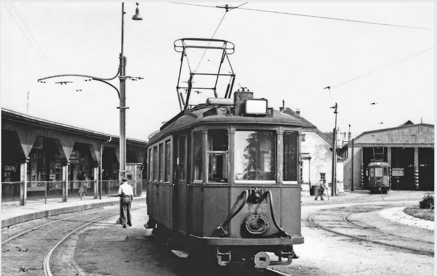
Verschubszene im Bahnhof Hütteldorf: Der Fahrer des N 2735 wechselt den Führerstand und der Verschieber stellt die Weiche für die Einfahrt in das richtige Hallengleis. Foto: Harald Herrmann / Archiv Wolfgang Simetsberger, 13. Mai 1955.
