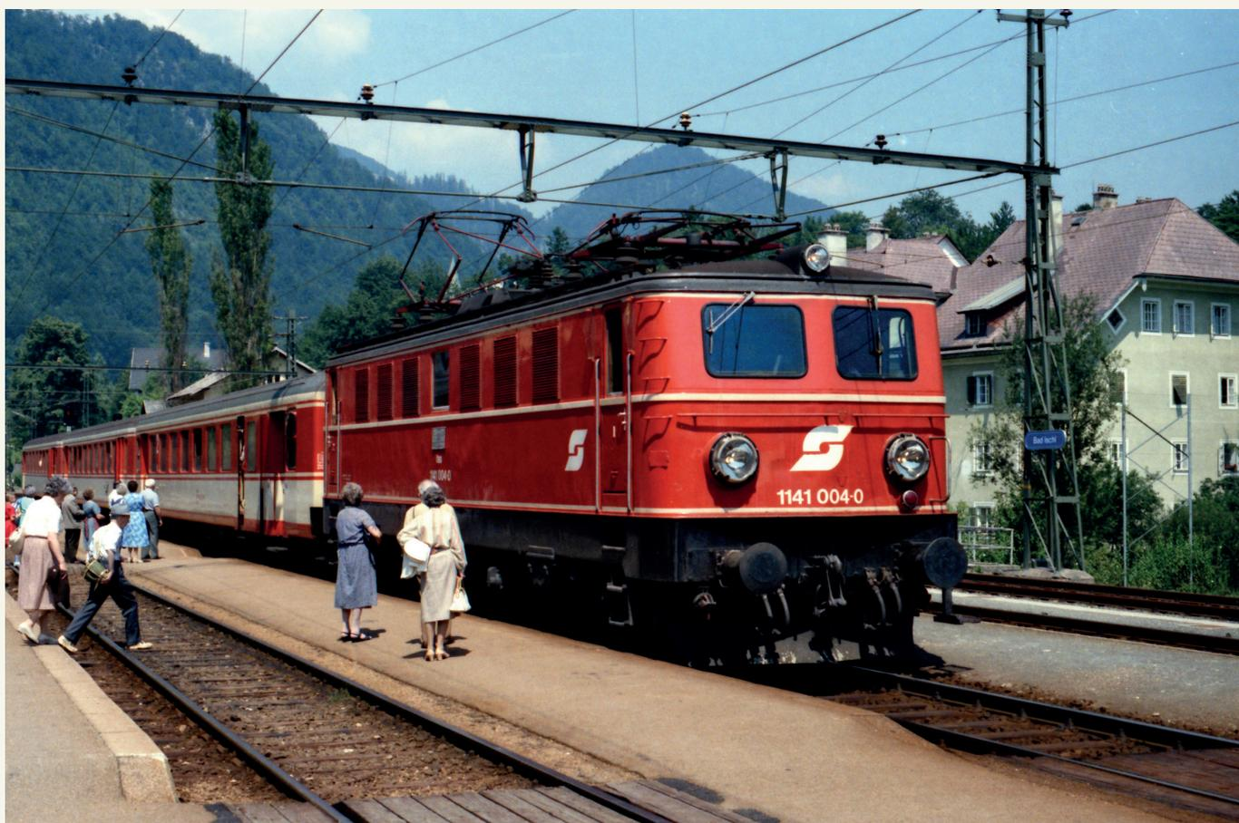
Der Zug in Richtung Bad Aussee wird am 16. Juli 1986 von den Reisenden bereits erwartet. Die Zugbildung war im Salzkammergut für die 1980er-Jahre typisch. Zuglok Reihe 1141, die das Rückgrat der Traktion bildete, mit drei „kurzen“ Schlierenwagen. (Foto Werner Prokop)
