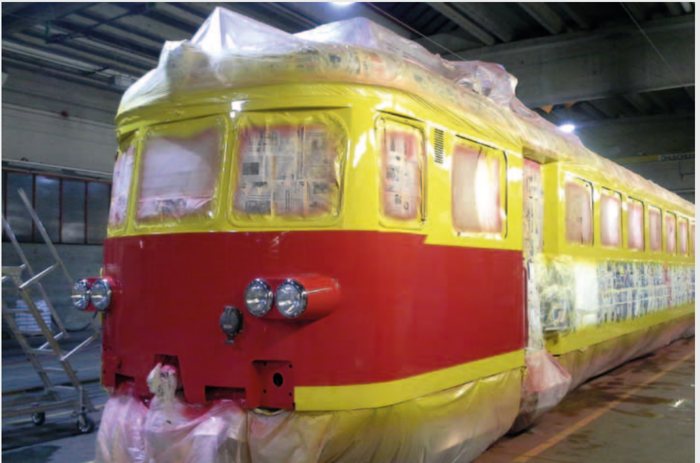
Die Triebwagenfront des ET 10.104 ganz frisch in Karminrot und Ginstergelb lackiert, die Abklebearbeiten haben gerade begonnen. Das Bild zeigt den TW am 24.04.2015 in Wolfurt. (Robert Köfler)
