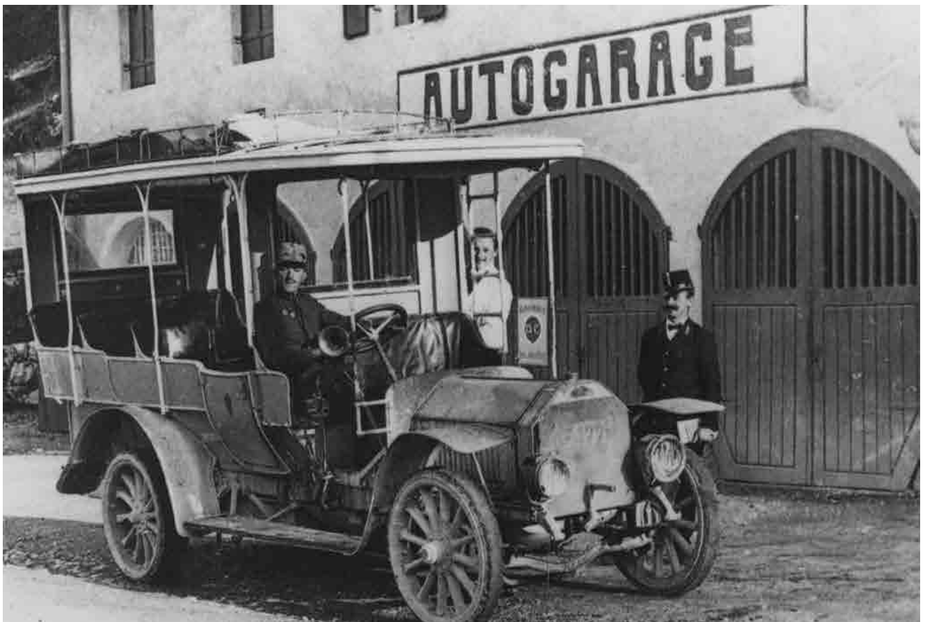
Das Bild zeigt den speziell für die Bergstraßen Südtirols entwickelten „Dolomitenbus“, eingesetzt auf der Linie Bozen – San Martino. Zu beachten sind die Hartgummiräder.
