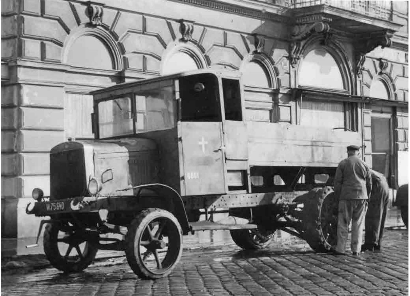
Ein Gräf & Stift Subventionslastwagen im Einsatz der Gemeinde Wien mit Vollgummireifen. An der Hinterachse ist der Kettenantrieb gut zu erkennen. (Archiv 1.öSEK-Sammlung Walter Kramer)
