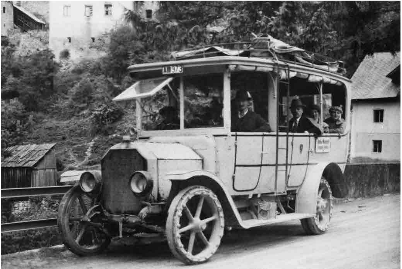
Der legendäre Postbustyp „ET 13“ mit Vollgummiräder, eingesetzt auf der Linie Imst–Nassereith–Fernpaß–Lermoos. Am Dach wurde damals das Gepäck der Reisenden transportiert und mit einer Plane gegen den Regen geschützt, die Aufnahme entstand im Jahr 1913. (Archiv Verein zur Förderung der historischen Fahrzeuge der österreichischen Automobilfabriken)
