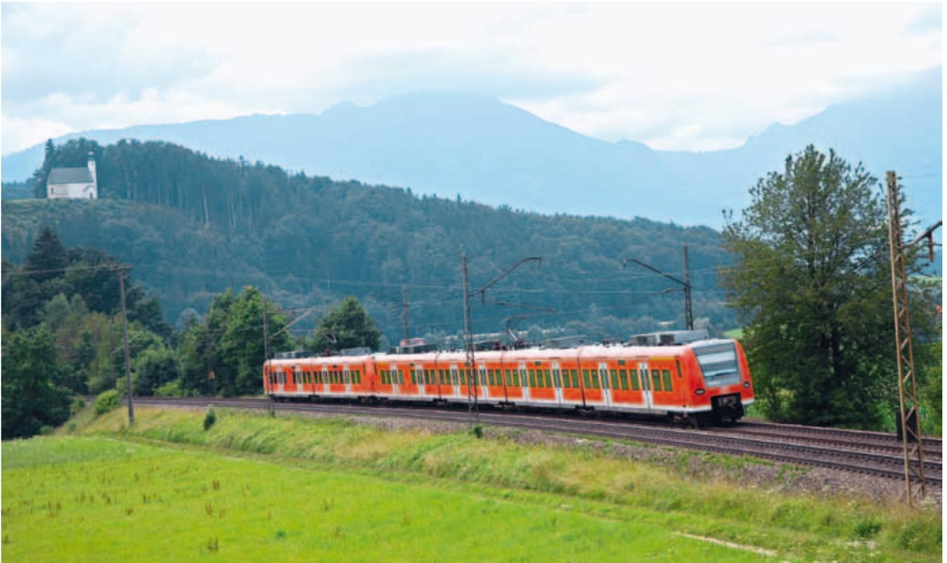
*Triebwagen der Baureihe 425 und 426 zwischen Bergen und Traunstein. Im Bild erkennt man noch die alten Gittermasten aus dem Jahre 1928, die inzwischen durch Betonmasten ergänzt wurden.*
