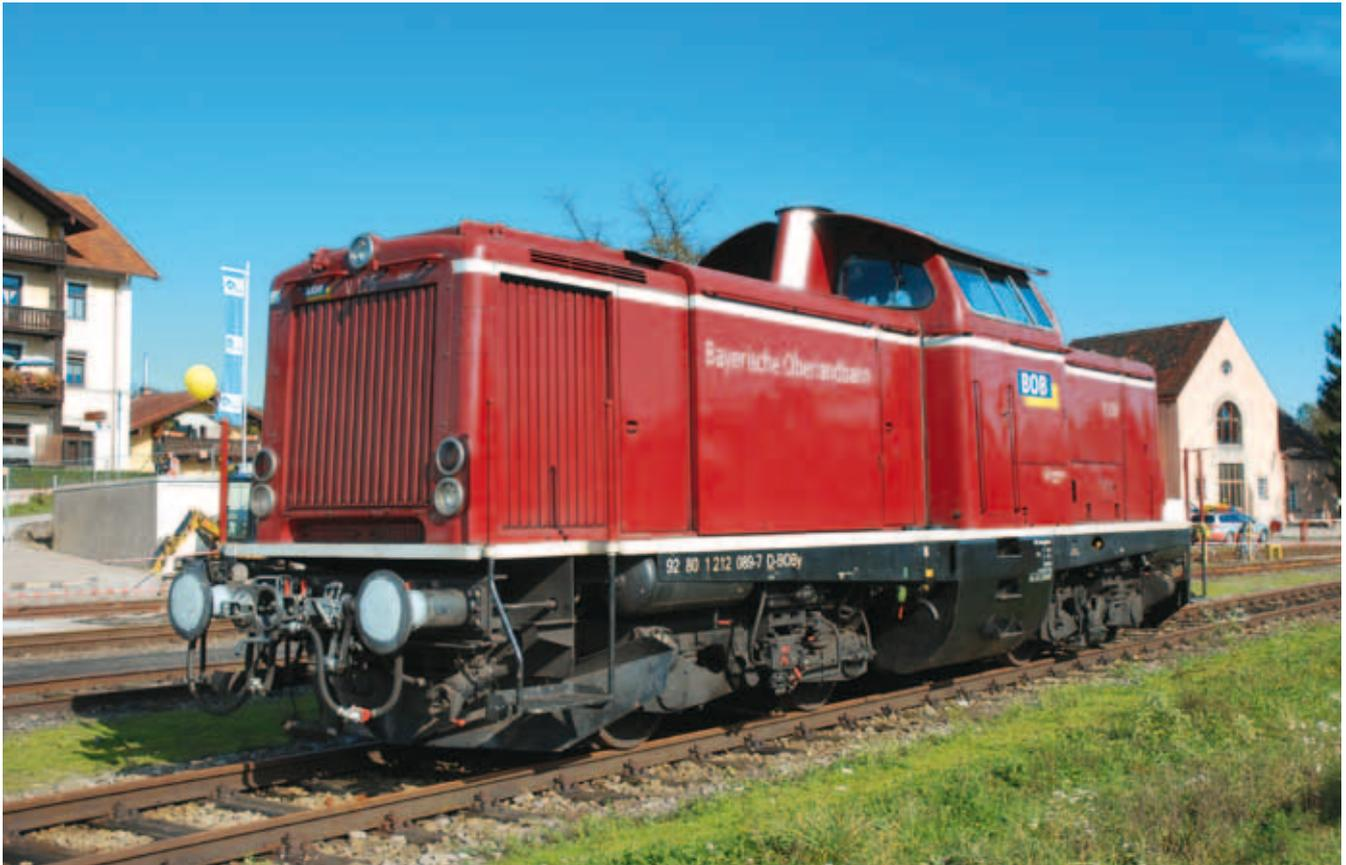
Eine Ex-V100 der DB fungiert bei der Bayerischen Oberlandbahn als Schlepplokomotive für elektrische Triebwagen, die auf nicht elektrifizierten Strecken befördert werden müssen. Damit können z. B. Meridian-Züge von Holzkirchen nach Lenggries, dem dortigen Betriebswerk von Transdev, zugeführt werden. JG
