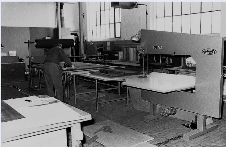
In der Holzbearbeitung richtet man die Polsterfertigung ein. Das Lager nimmt den größten Teil ein, da ein Schlierenwagen immerhin über 72 Sitze, die Wagenserie 20-75 über 80 Sitze verfügt.
