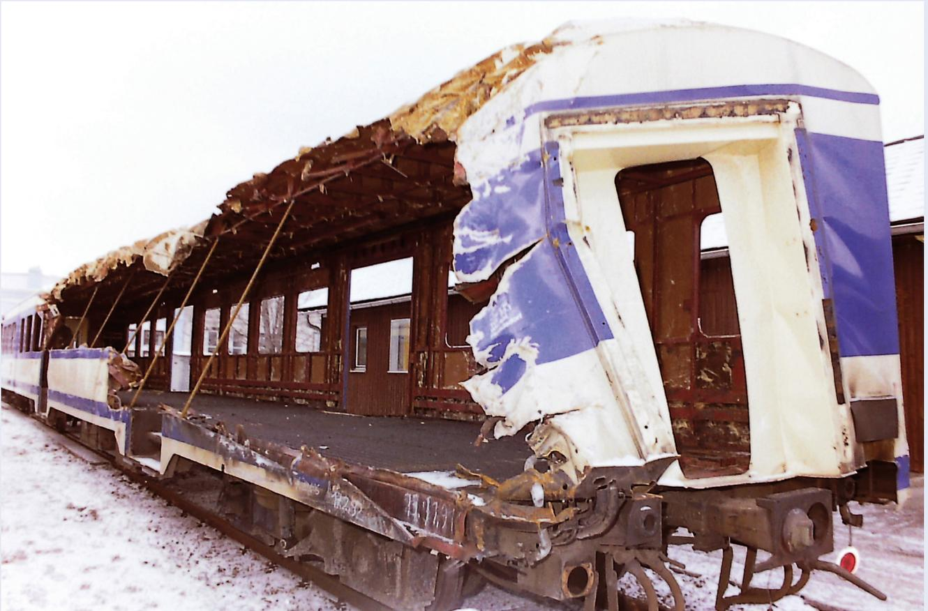
1992 erfolgte eine Aushilfe für die Hauptwerkstätte Floridsdorf: Der Steuerwagen 6020 027 und die Zwischenwagen 7020 006 und 7020 027 erhielten von der Z-Abteilung eine Sanierung des Untergestelles und kompletten Neuaufbau des Wagenkastens. Nach dem Lackieren gingen die Wagen zur Fertigstellung in die Hauptwerkstätte Floridsdorf zurück. Diese Aushilfe war notwendig, weil mehrere 4020-er Garnituren am 9. November 1991 gleichzeitig einen schweren Unfall hatten.
