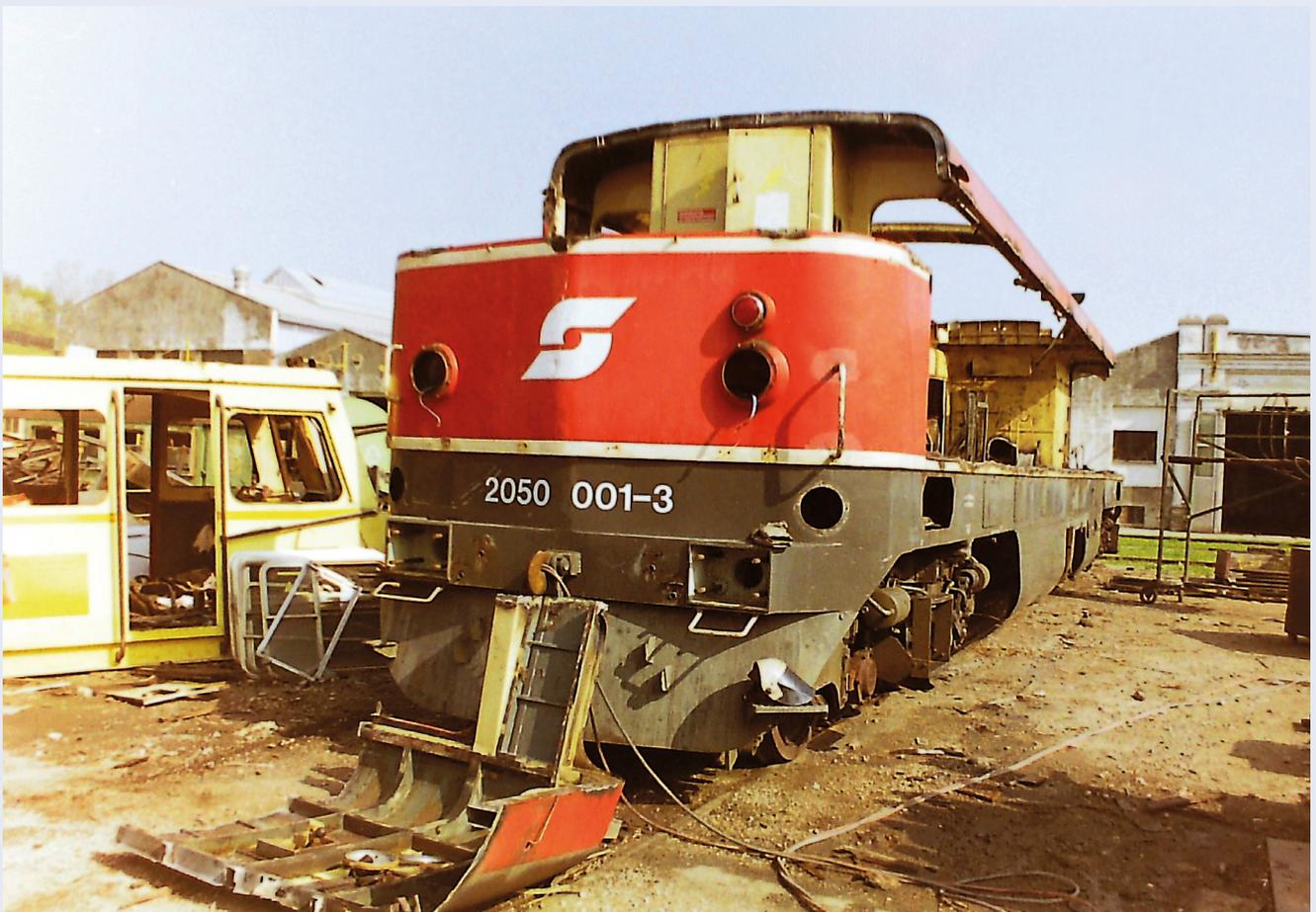
Beispiel Altstoffverwertung: Zerlegung der Lok 2050 001 im August 1994. Sie wurde als erste ihrer Reihe ausgemustert. Die Metalle wurden sortenrein getrennt in Stahl, Kupfer und Aluminium. Durch die Trennung erzielte man hohe Preise für das Altmetall. Nicht verwendbare Teile (z.B. Isolierungen) wurden fachgerecht entsorgt.
