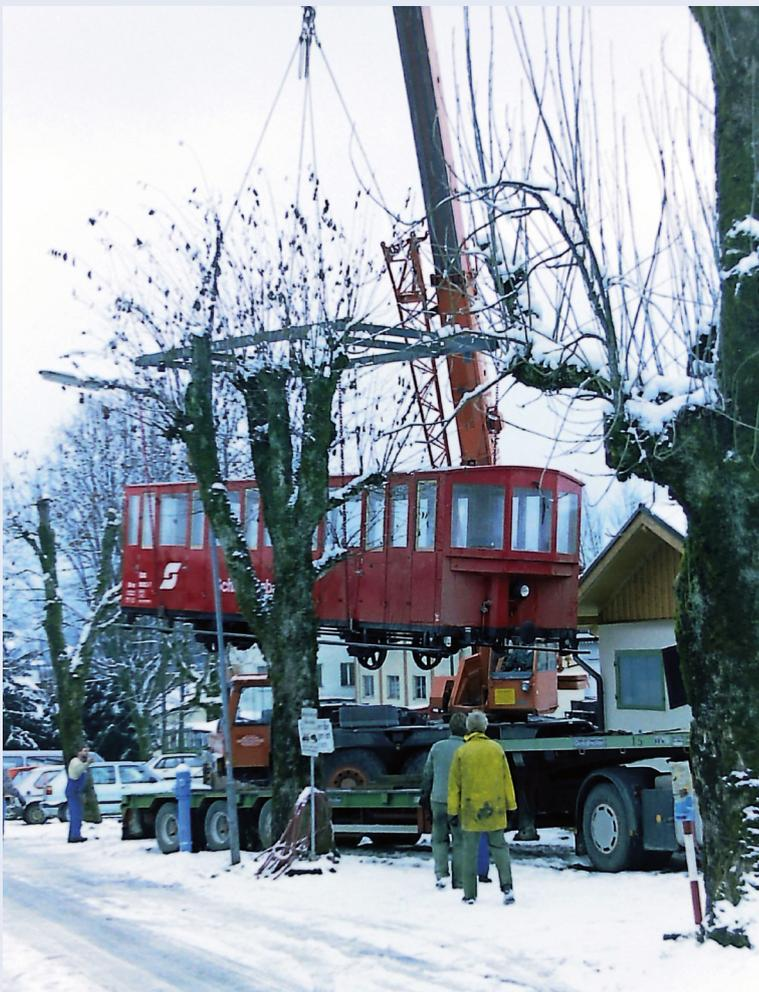
Beim Abladen des Wagens bewiesen LKW-Fahrer und Kranführer ihr Geschick. Der Wagen musste zwischen den Bäumen und dem Haus manövriert werden. Für das Abladen musste ein spezielles Zwischengeschirr angefertigt werden, damit der Wagenkasten nicht beschädigt wird.
