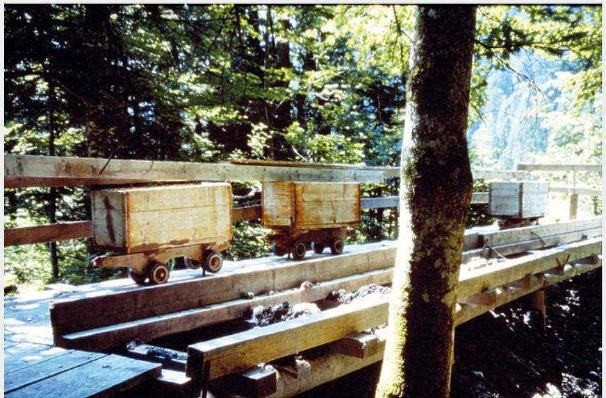
*Die noch erhaltenen Spurnagelhunde beider Bauformen aus dem Salzbergbau in Altaussee zeigen noch die gusseisernen Räder vor dem Umrüsten auf gummierte Räder.*
