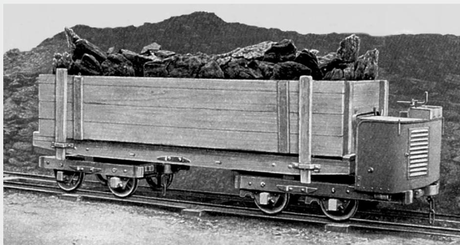
*Ein etwas geändertes Bild aus einem Puch-Prospekt zeigt einen, für zivile Transportleistungen hergestellten 3 t Plattform-Triebwagen mit Aufbau, der mit einer Leistung von 4,2 PS jenen Motorfeldbahntriebwagen ähnelt, die im 1. Weltkrieg Verwendung fanden.*
