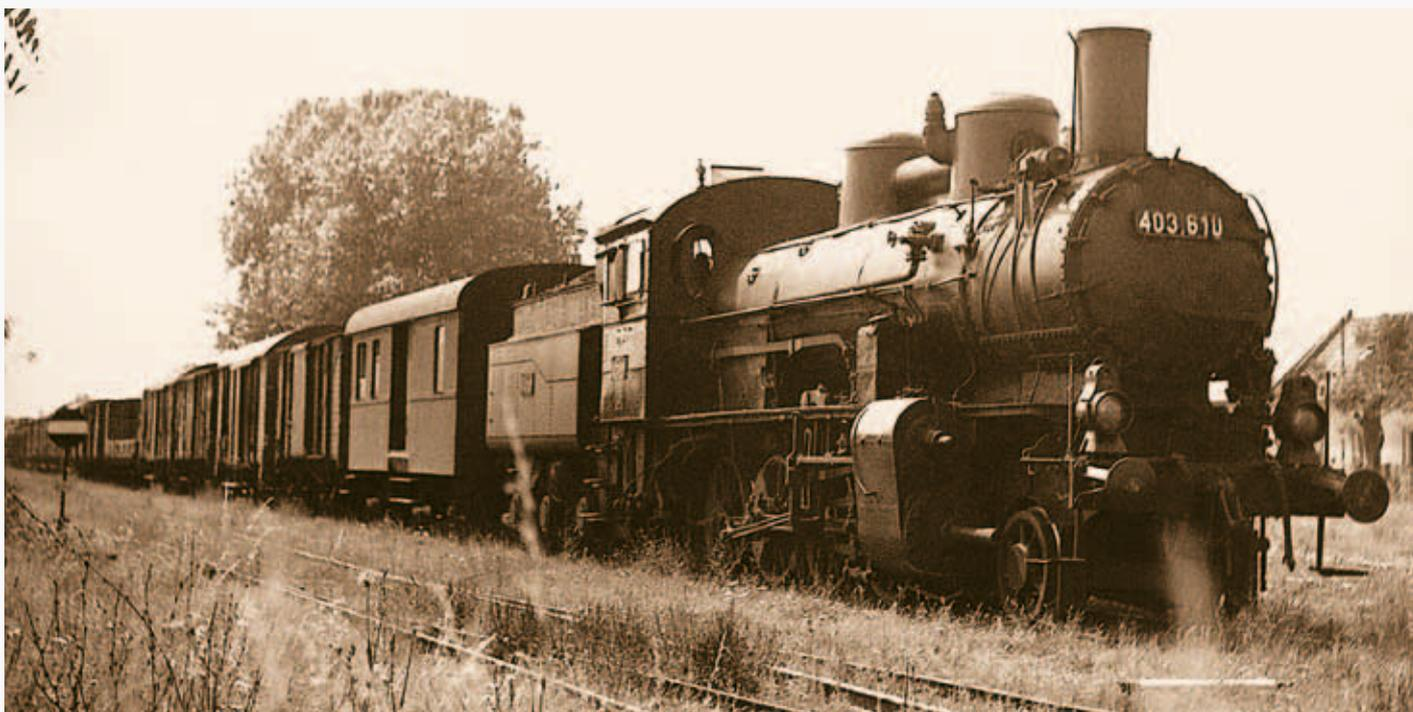
*Mit Doppeldom und Verbindungsrohr präsentierte sich die 403.610, hier im Unkraut überwucherten Bahnhof Neufeld an der Leitha. (Beide Aufnahmen aus dem Sommer 1963).*
