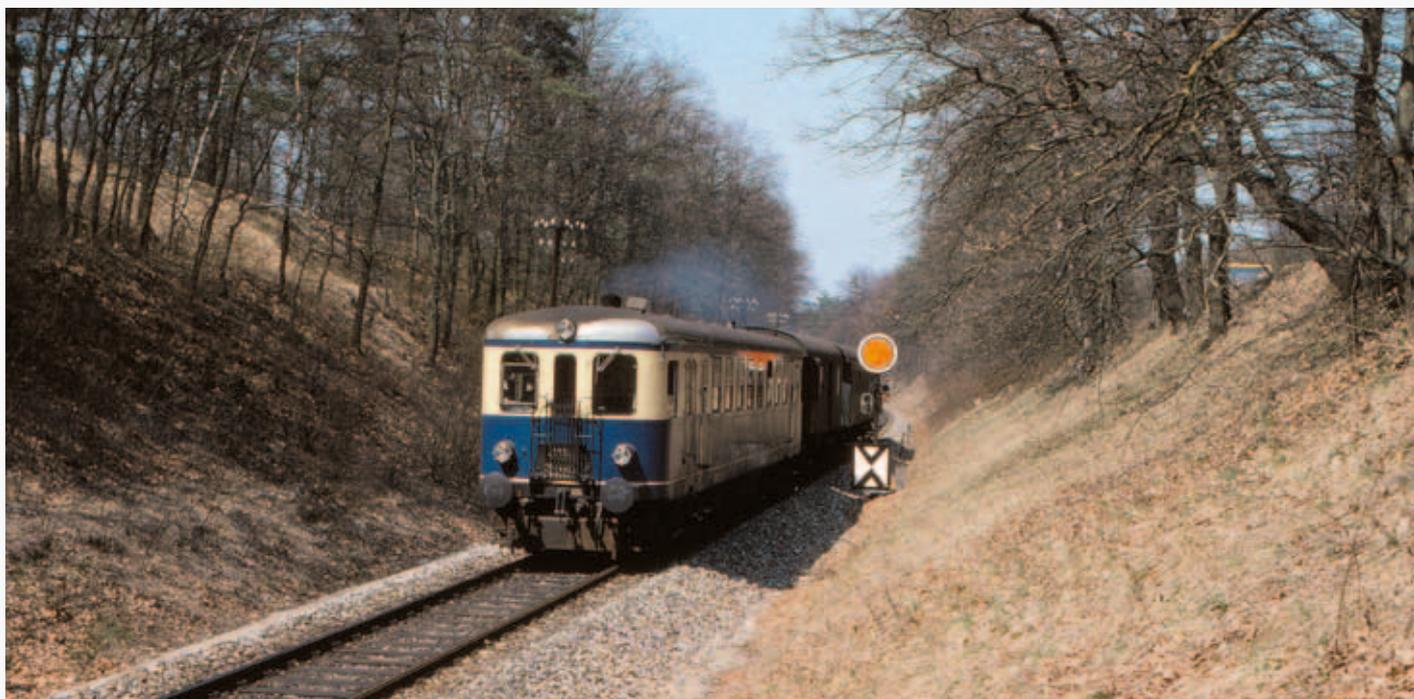
*Den Personenverkehr besorgten damals Triebwagen Reihe 5044. Einer davon wurde im selben Einschnitt zwischen Neudörfel und Sauerbrunn abgelichtet. Das Vorsignal gehört zu dem auf dem oberen Foto abgebildeten Hauptsignal. (Foto vom 12.4.1979)*
