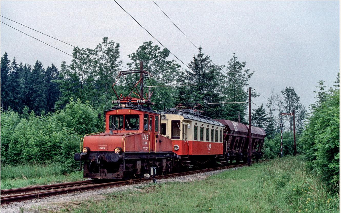
*Eine eher exotische Zuggarnitur aus E 24.010 und dem Triebwagen ET 24.103 mit zwei Schotterwagen im Schlepp hat 2002 gerade Bahnhof Stadl-Paura verlassen. Hinter dem Zug ist das Einfahrformsignal des Bahnhofs erkennbar, zu diesem Zeitpunkt war der altösterreichische Signalflügel bereits durch einen rückstrahlenden Löffel ersetzt worden.*
