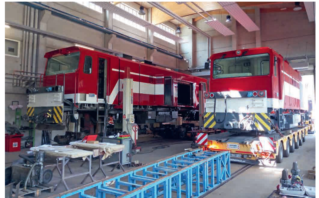
Diesmal lud man die Lokomotive in der Remise der Zugförderung Tischlerhäusl mit Hilfe einer zerlegbaren Rampe ab. Am Nachbargleis ist die im Farbschema der SLB neu lackierte Vs 84 zu sehen, welche als D 13 an die Zillertalbahn geliefert und per 1. August 2018 von den SLB angekauft wurde. Foto: Thomas Oberkalmsteiner
