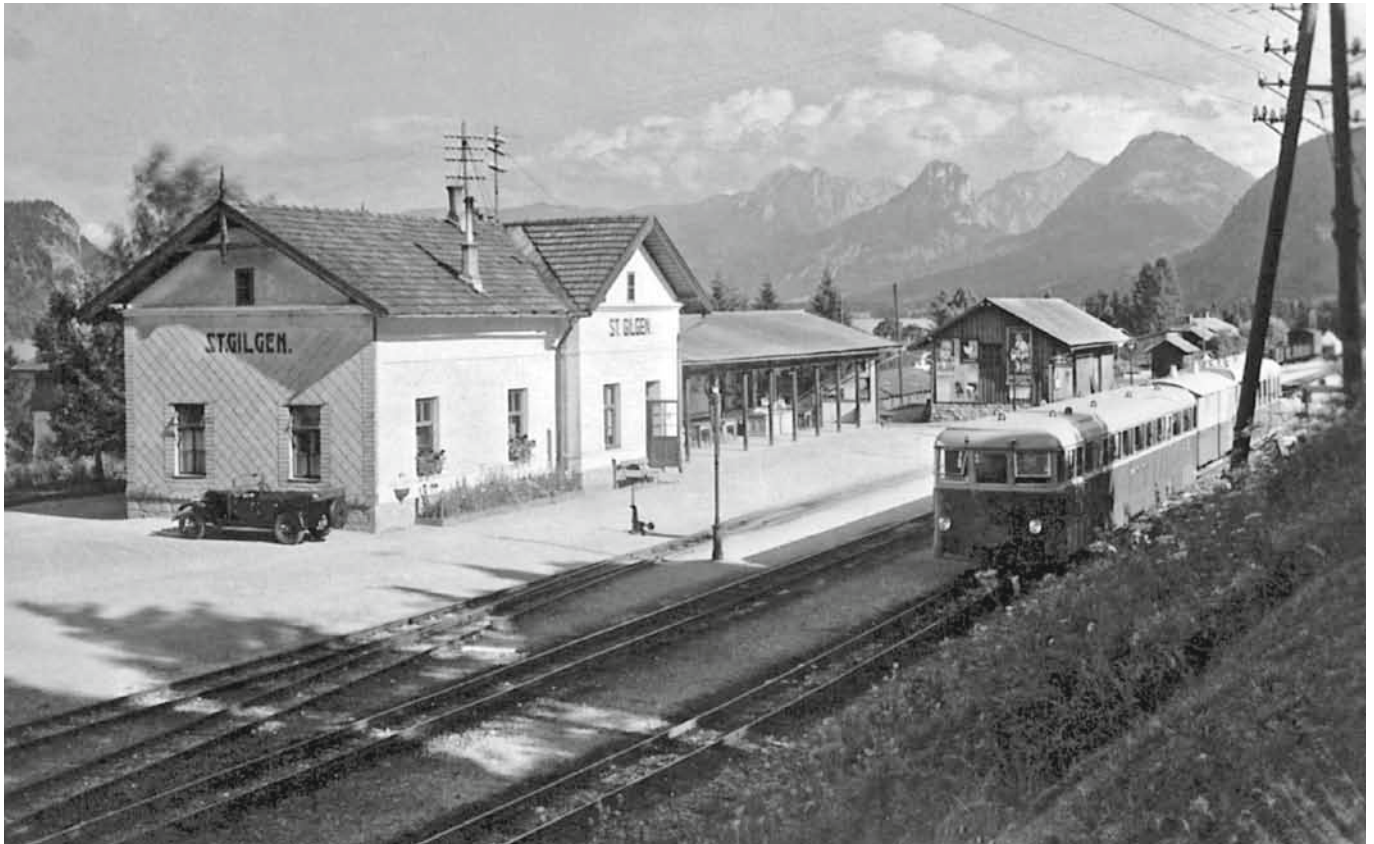
Als kleine Sensation darf dieses Foto aus der Sammlung des Ortsarchivs St. Gilgen gewertet werden. Es zeigt einen der Austro-Daimler-Triebwagen, wahrscheinlich den TBCa 456, mit einem zweifarbig lackierten Dienstwagen (D 759 oder 765) einen ebensolchen vierachsigen Personenwagen aus der Serie Ca 652-660. (Foto vermutlich vom 18.08.1933)
